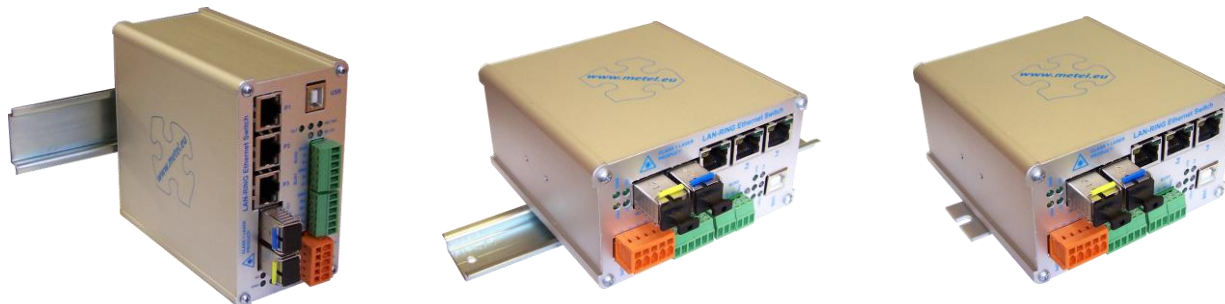
Montaż pionowy na DIN35* Montaż poziomy na DIN35* Montaż na płaskiej powierzchni*
